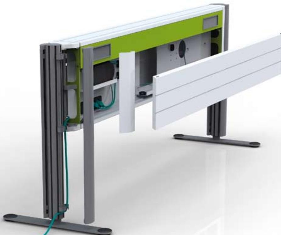
Additiva besteht aus zwei Profil-Seitenelementen mit Standfuß und der dazwischen gesetzten E-Box. Die Position der E-Box ist in der Höhe einstellbar. Die Box ist durch eine Mittelwand in zwei Kammern für die beiden gegenüber stehenden Schreibtische geteilt. Den oberen und unteren Abschluss der E-Box bilden zwei Aluminiumprofile mit Funktionsnuten, die Adaptionen wie z.B. Monitorhalter aufnehmen.
